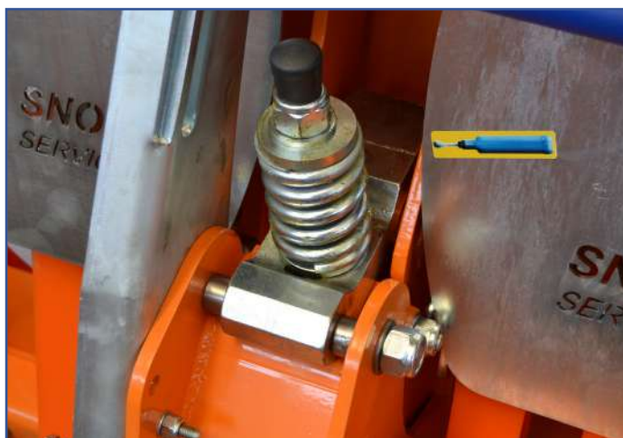
Martelletti di ritenuta per regolazione durezza sgancio ed evitare vibrazioni
