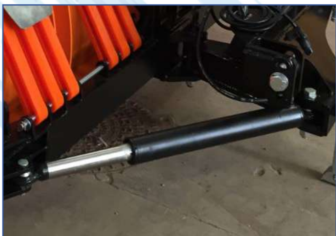
Orientamento idraulico con cilindri a semplice effetto
