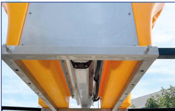
Struttura spargisale in PPL a doppia parete, canale di scorrimento coclea in acciaio inox e coclea in acciaio
